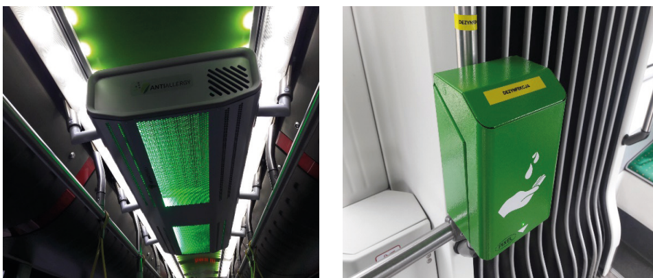
Rysunek 3. Urządzenia do dystrybucji płynu dezynfekcyjnego (z prawej, 22 listopada 2020 roku) i do filtrowania powietrza i dezynfekcji pojazdów (z lewej, 21 czerwca 2020 roku)
